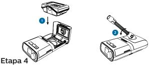
Volte a colocar cuidadosamente o reservatório de água (1) no humidificador e feche a tampa do humidificador (2) até encaixar e fechar.
